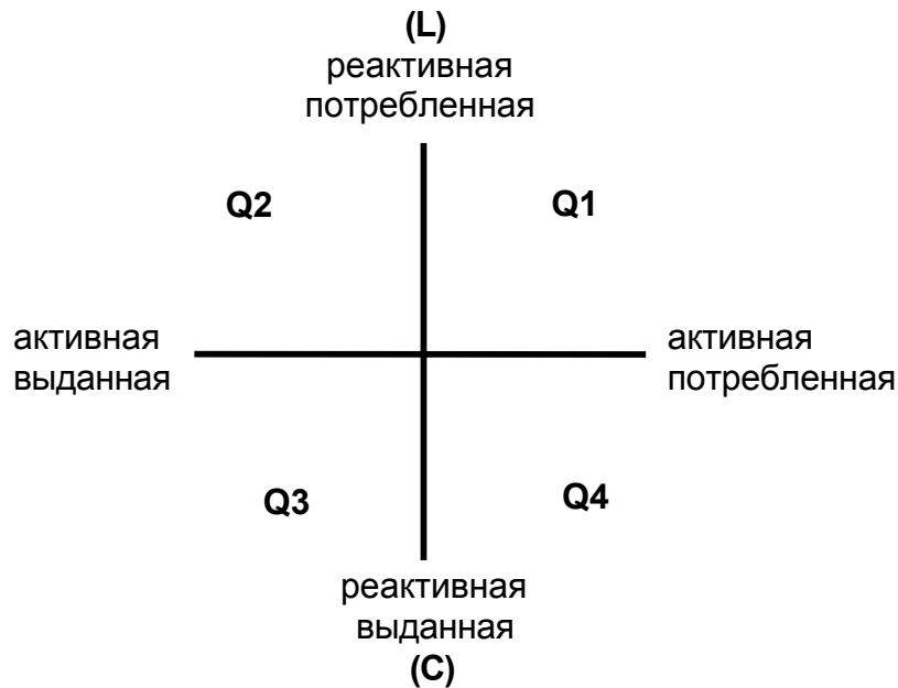
Рисунок 11 - Привязка квадрантов ЖКИ к осям P и Q
